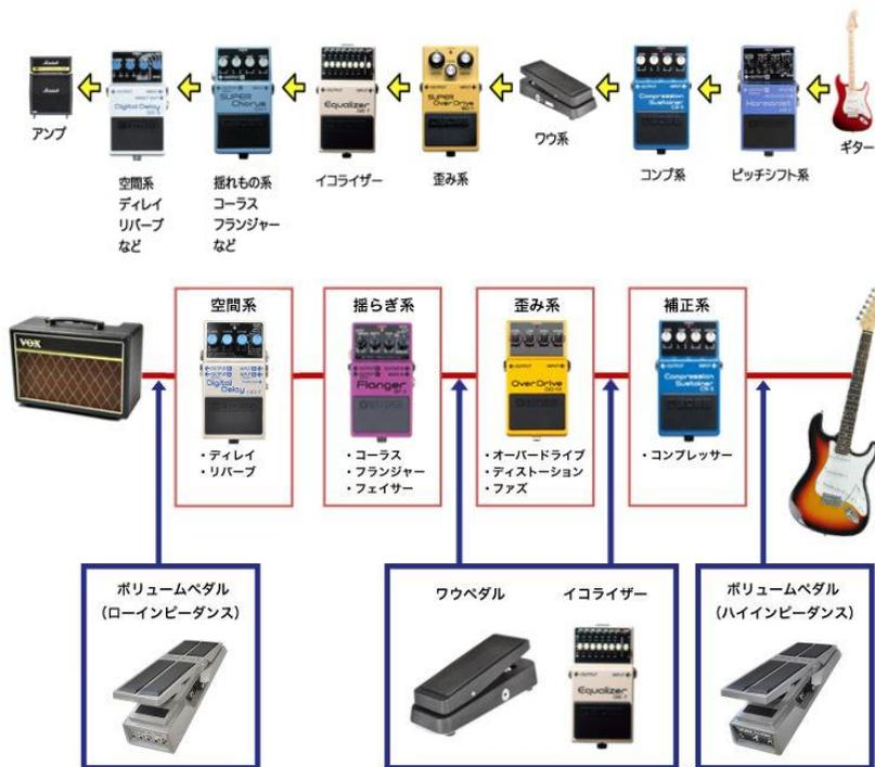
ブースターは音量を上げるエフェクターです。しかし、画像の上側のように、歪み系の前にブースターを接続した場合、後に接続されている「歪み系」で調整される音量が優先されるため、「ブースターで音量を上げる」という効果を完全に発揮することは出来なくなります。
