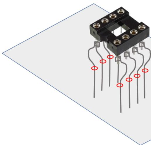
ICソケット+バスワイヤー (22AWG) を絶縁板に取り付ける。
