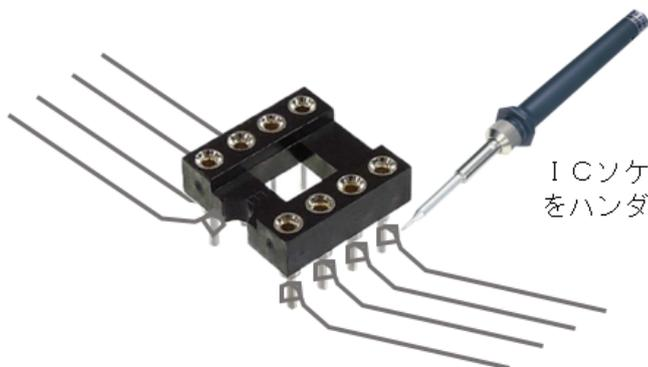
ICソケットの足にバスワイヤー (22AWG) をハンダ付けする。
