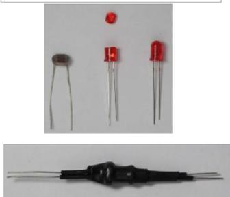
LEDとCDSを使用した光結合器(アナログフォトカプラ)です。内部はCDSとLEDが向き合って配置されています。入力側の電流の変化に応じて出力側の抵抗値が連続的に変化します。アナログフォトカプラは電流の変化を抵抗値の変化に置き換えることが出来ます。通常のフォトカプラと異なり、純粋な抵抗として作用しますのでアナログ信号の制御等に適しています。エフェクタ、アナログシンセサイザー、オペアンプのフィードバック等、アナログ信号経路の光結合に最適です。
