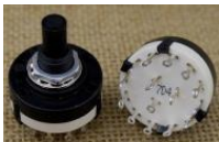
Alpha 3回路 2-3-4接点 シャフト: φ1/4"(18mm、ねじ部8mm) プッシング径(ねじ部): φ9mm ノンショート型
